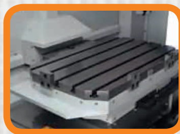
Pracovní stůl odolný proti vniku třísek - díky speciálnímu vnitřnímu krytování se zabrání vniku třísek během automatické výměny palet
