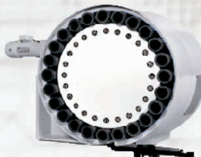
Automatický zásobník nástrojů s kapacitou 24 nástrojů, kužel ISO 40 (standard)
