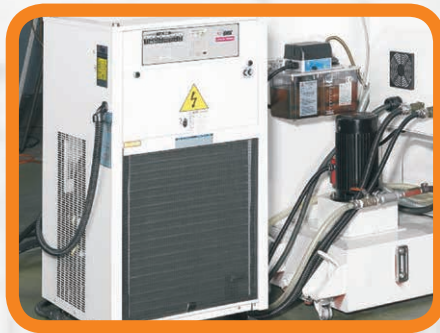
hydraulická jednotka pro olejový chladič vřetena
