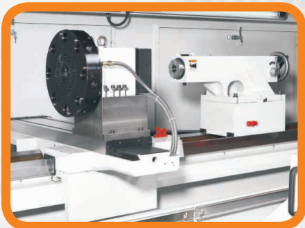
elektrická revolverová hlava SAUTER + disk VDI40
