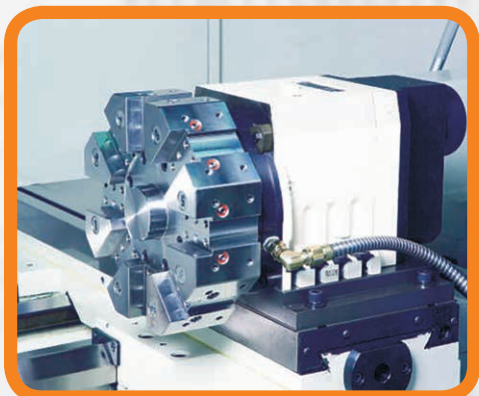
8-polohová hydraulická revolverová hlava LS-160 + Japanese disk
